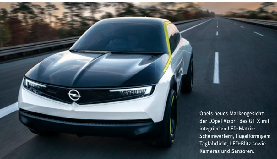
Opels neues Markengesicht: der „Opel-Vizor“ des GT X mit integrierten LED-Matrix-Scheinwerfern, flügelartigem Tagfahrlicht, LED-Blitz sowie Kameras und Sensoren.
