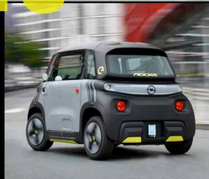
Gokart-Feeling pur: Das Opel-Team hat dem Rocks-e einen Radstand von 1,73 Meter verpasst. In der Praxis ergibt das einen Wendekreis von 7,20 Meter. Vorne arbeitet eine Einzerradaufhängung in Verbindung mit der hinteren Verbundlenker-Achse. Gestoppt wird per Scheibenbremsen vorne und Trommelbremsen hinten.
