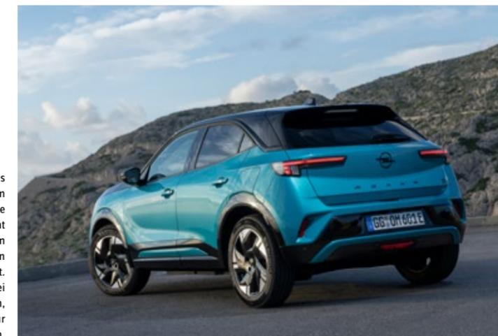
Schnell und intuitiv erklären sich die drei möglichen Fahrmodi von selbst: Sport, Eco und Normal. Die Leistung des Elektroantriebs gibt der Hersteller mit 115 kW (156 PS) an und 260 Nm Drehmoment. Die Höchstgeschwindigkeit liegt bei 150 km/h und ist elektronisch abgeregelt. Die Beschleunigung von 0 auf 100 km/h erreicht der Stromer in 9 Sekunden.
