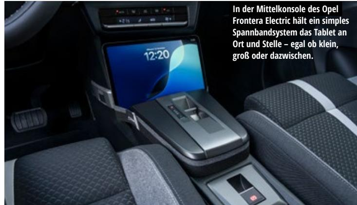
In der Mittelkonsole des Opel Frontera Electric hält ein simples Spannbandsystem das Tablet an Ort und Stelle – egal ob klein, groß oder dazwischen.
