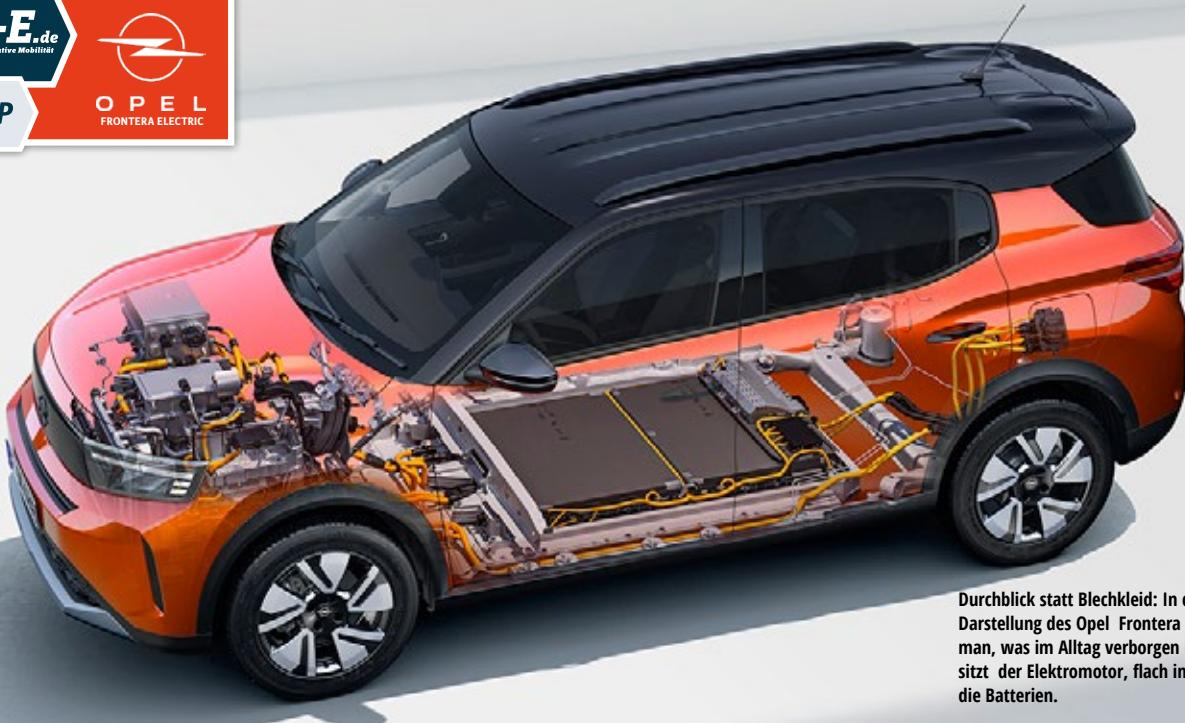
Durchblick statt Blechkleid: In der technischen Darstellung des Opel Frontera Electric sieht man, was im Alltag verborgen bleibt: vorn sitzt der Elektromotor, flach im Boden lagern die Batterien.
