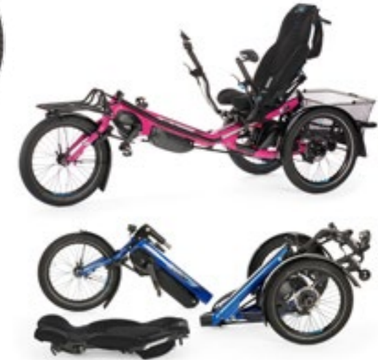
Das Delta tx lässt sich übrigens auch in wenigen Handgriffen zerlegen zum Transport im Auto
