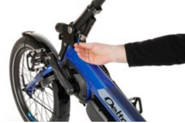
Der neue Kardanlenker lässt sich für den Einstieg nach vorne wegklappen und ermöglicht präzises Steuern in Kurven auch mit kleinen Armbewegungen..
