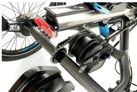
Die Räder sind mit Automatikschaltungen versehen, die perfekt zu den Motorprofilen passen. Das ermöglicht eine Fahrt stets im optimalen Kraftbereich.
