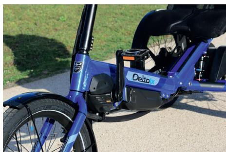
Vier verschiedene Mittelmotoren stehen zur Auswahl: Vom Bafang M300 bis hin zum Shimano STEPS Cargo-Motor EP801.
