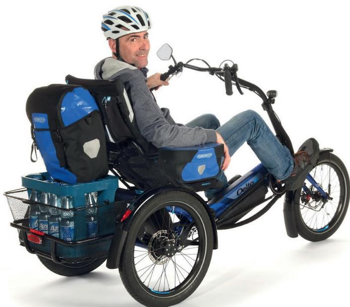
Optimale Gewichtsverteilung zwischen den Hinterrädern. Der extragroße Korb gehört zur Basis-Ausrüstung. Der Gepäckträger ist mitgefedernd und bietet eine maximale Zuladung von 25 Kilogramm.
